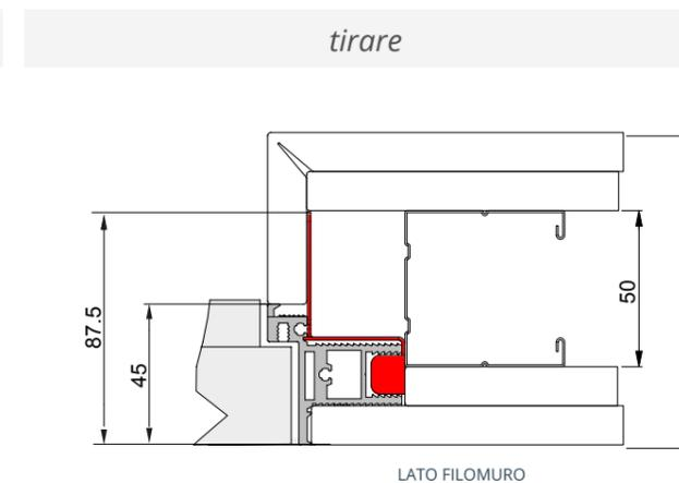
**i** Le staffe di fissaggio, 8 in dotazione, sono per cartongesso tirare e cartongesso spingere. Possono essere montate anche su pareti intonacabili e contribuiscono a rinforzare il fissaggio. La parete minima realizzabile, con staffe montate, è di 87,5mm.
